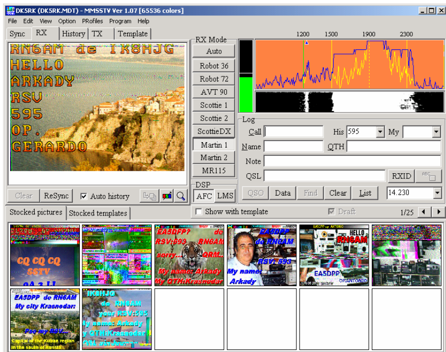
Bild 7: Screenshot des Freeware SSTV-Programmes MMSSTV von JE3HHT. Die Frequenzeinstellung ist vergleichsweise einfach. Insbesondere hat mir die exakte Schräglauferkorrektur gefallen, die sich hinter dem Reiter „Sync“ verbirgt. Sonst hat das Programm etwa den Bedienkomfort, den man auch von den anderen SSTV-Soundkarten-Programmen kennt.
